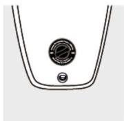
Pritisnite zatik ventila sa prstom prema dolje i zakrenite ga u LIJEVO (u smjeru suprotnom od kazaljke na satu) Stjenka ventila otpušta u smjeru prema gore.
