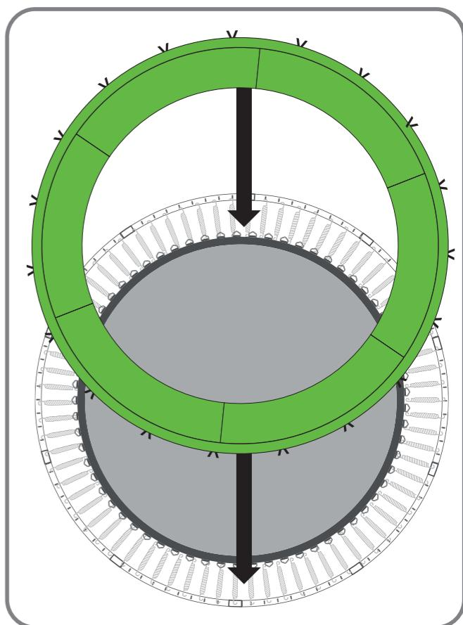
8. Pričvrstite gumene trake zaštite okvira (2) na glavni okvir. Unutarnje elastične trake pričvrstite na trokute opruga.
